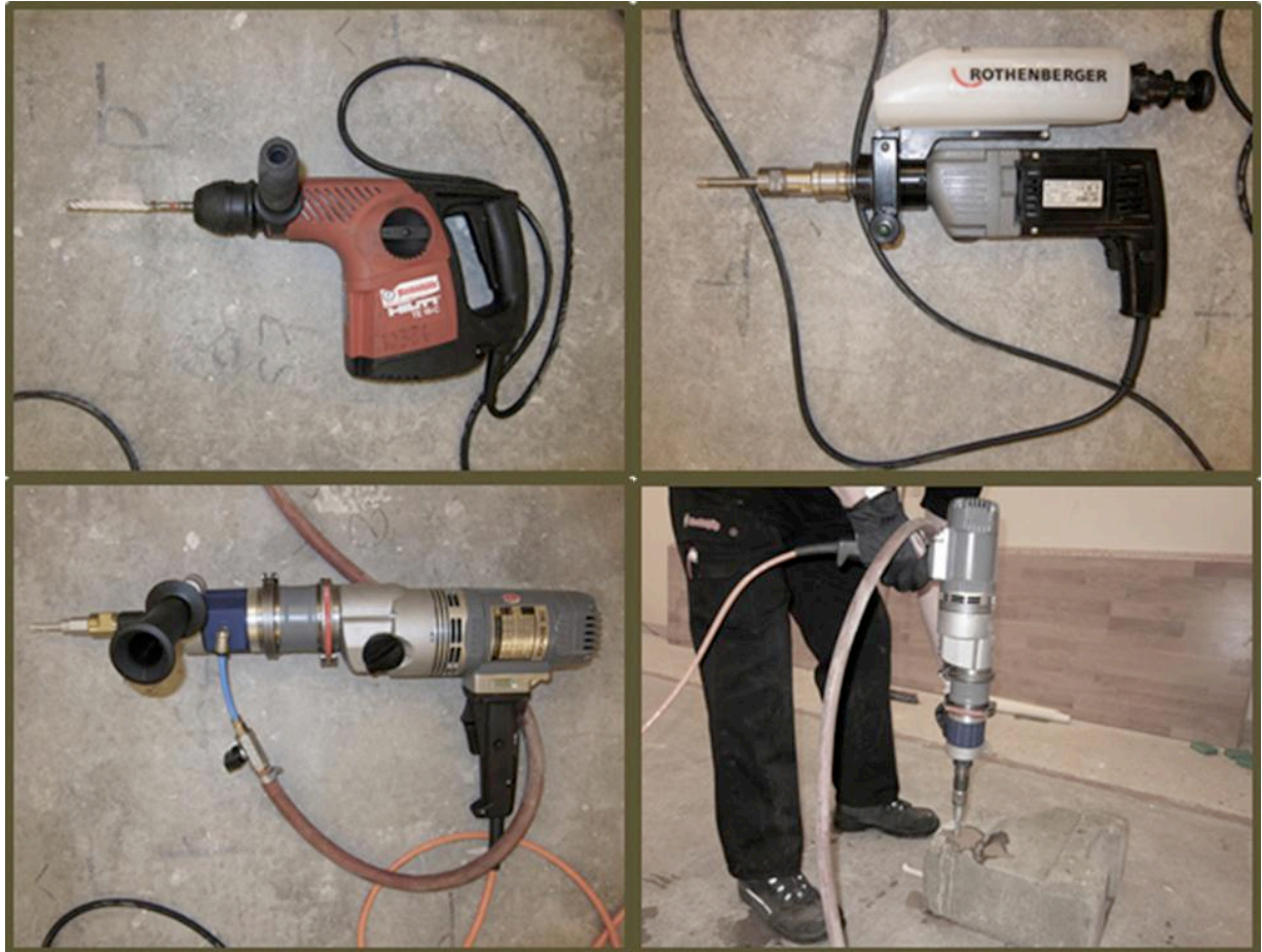
Figur 4.9. Bormaskiner i testet: (övre vänster) konventionell slagbormaskin "Hilti" med hårdmetallborr; (övre höger) maskin "Rothenberger", med påbyggd vattentank och ihåligt kärnborr med diamantspets; (nedre vänster) maskin "Dr Bender" med massiv diamantborrspets och vattenslang; (nedre höger) borrhning i betongblock i SP:s stegljudslaboratorium.
